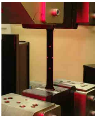
Figura 2.15. Probeta para determinación anisotropía plástica mediante video extensómetro
