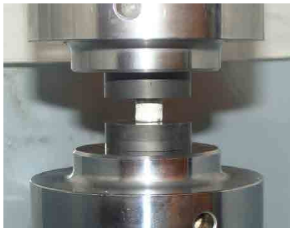
Figura 2.12. Probeta compresión envuelta con teflón antes de realizar ensayo de compresión.
