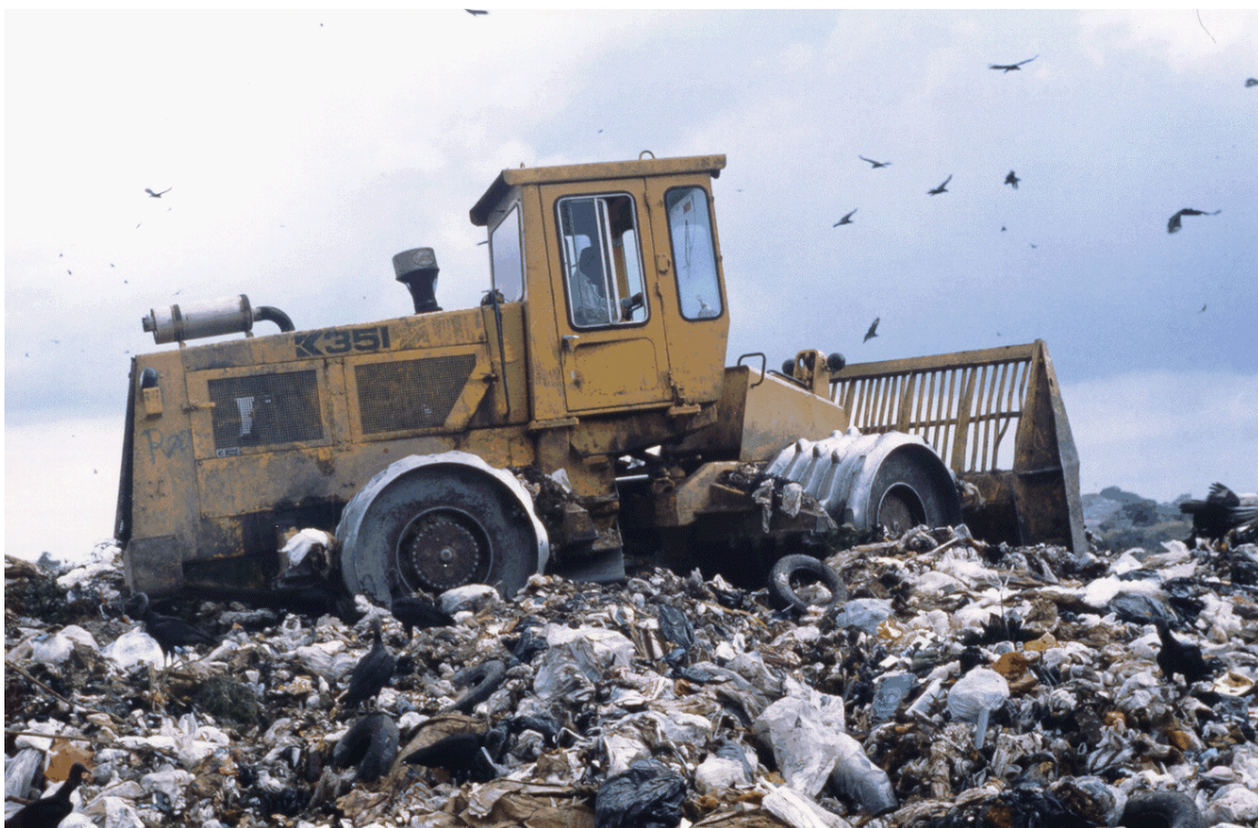
Fotografía 8. Compactación y trituración de los RSU (vertedero de Cerro Patacón, Área Metropolitana de Panamá)
