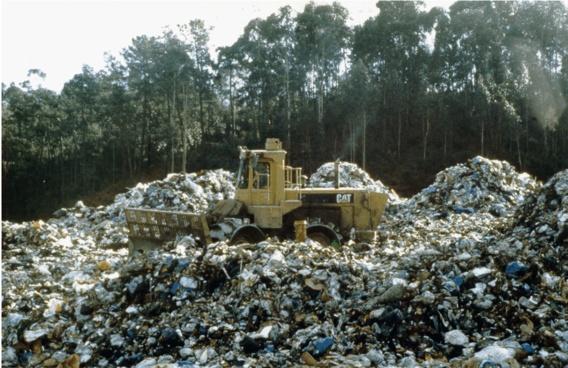
Fotografía 4b. Fases en el vertido por área: (b) Trituración
