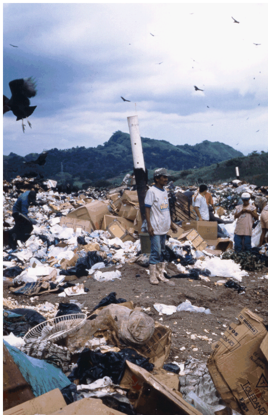
Fotografía 9c. Distintas chimeneas de venteo del biogás: (c) Cerro Patacón, Panamá
