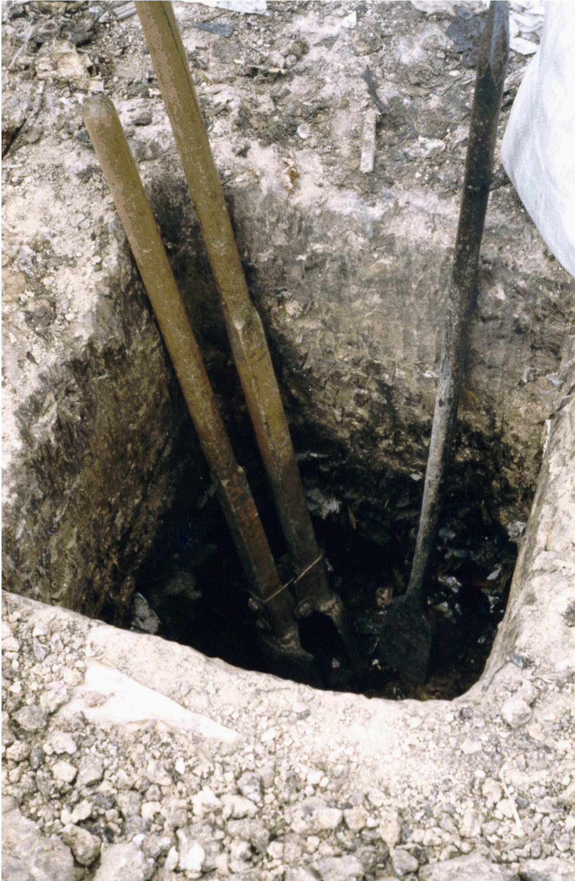
Fotografía 7. Comprobación de la densidad de los RSU y del espesor de cubrición (Doña Juana - Bogotá, Colombia -)
