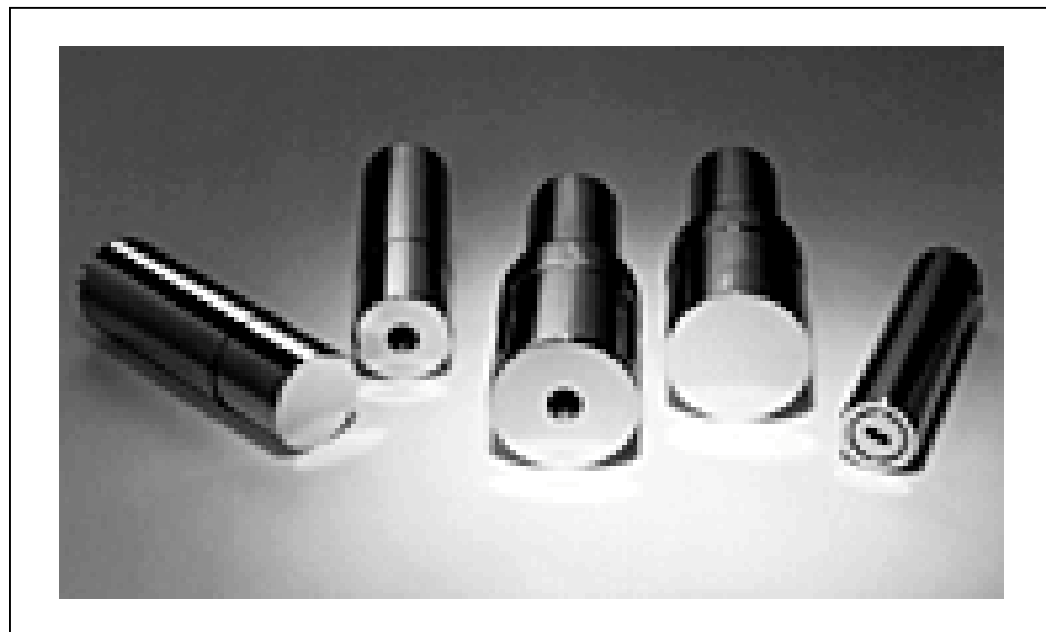
Foto 4 Detectores de centelleo de NaI (TI), (el modelo utilizado es el 2º por la derecha).
