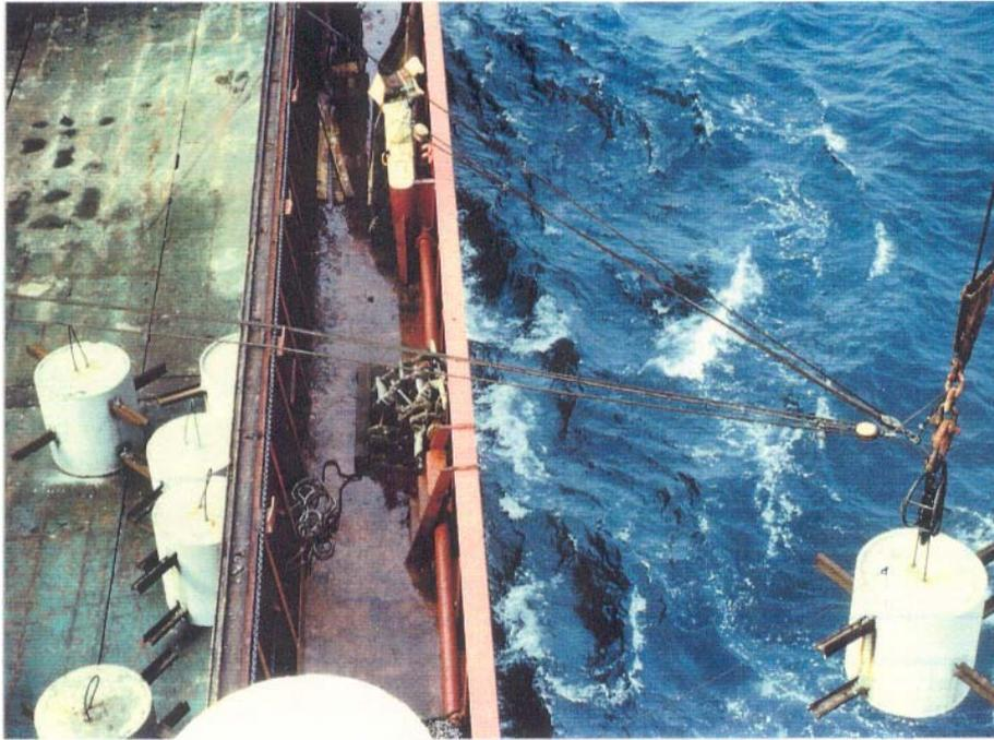
**Figura 25. Módulo en suspensión para fondeo en su posición.
