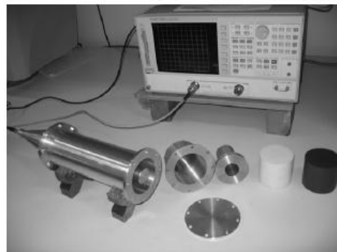
Figura 2.16 —Línea coaxial desarrollada para la medida en reflexión de muestras de hormigón (Adous et al. 2006).
