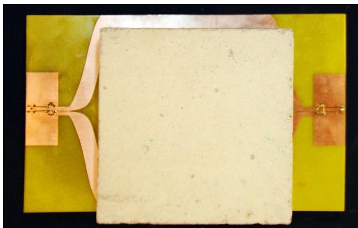
Figura 5.18 — Vista inferior de la configuración de medida de una probeta mediante el sensor CPS.
