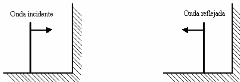
FIGURA 2.3. Reflexión de una onda de presión en el choque perpendicular contra un obstáculo (Stull, D.R., 1976).
