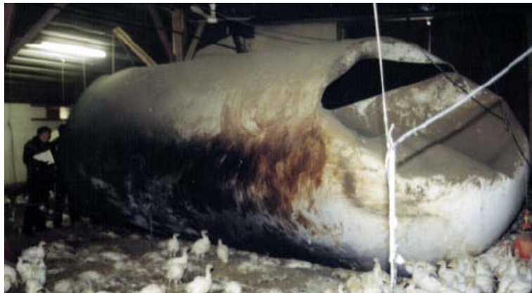
FIGURA 3.11. Fragmento de un recipiente que destruye la nave de la figura 3.10 en una granja en Albert City (Iowa) en 1998 (CSB, 1999).
