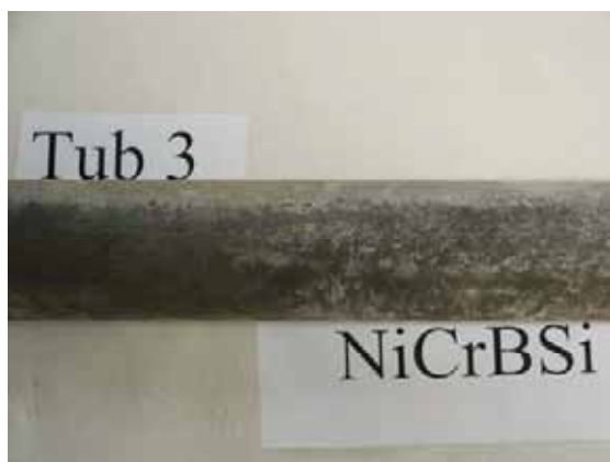
Fig. 4.14 a. Imatge digital d'un dels tubs recoberts amb NiCrBSi sortint de la caldera IRSU.
