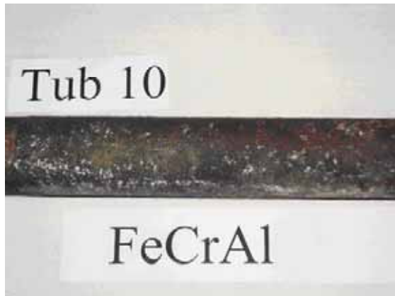
Fig. 4.27 a. Imatge digital de tub recobert amb FeCrAl sortint de la caldera IRSU.
