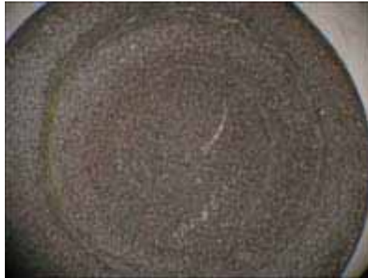
Fig.4.77 a. Superfície d'atac aparentment inalterada en l'observació amb lupa binocular.
