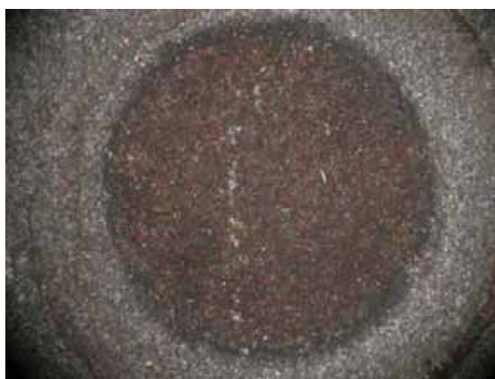
Fig. 4.96 a. Imatge superficial de lupa de les mostres de H 2 -C-6119 sota solucions salines de corrosió en calent.
