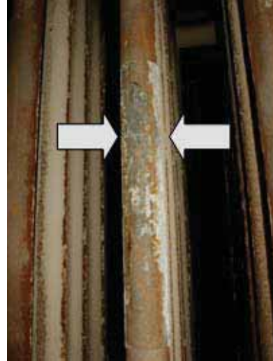
Fig. 4.6 b. Imatge tub recobert amb CoNiCrAlY en un bon estat superficial.
