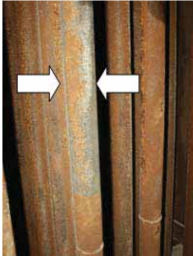
Fig. 4.4 a. Imatge tub recobert amb Cr 3 C 2 -FeCr amb un estat de degradació del recobriments avançada
