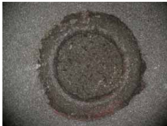
Fig.4.110 a. Superfície de l'assaig de corrosió sota 5%NaCl per C 3 H 6 -C-6119
