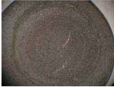
Fig. 4.62. Superfície avaluada per lupa binocular després de l'assaig de corrosió sota solucions salines.
