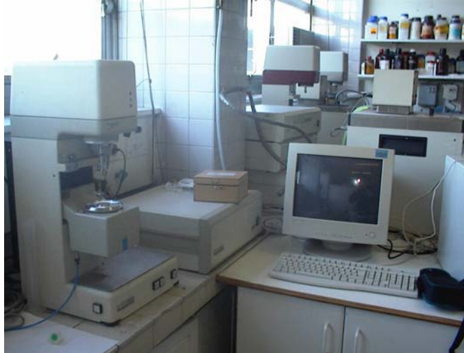
Figura 3-4 .- Fotografía del reómetro Haake RS100 con el que se ha medido la viscosidad de las muestras.
