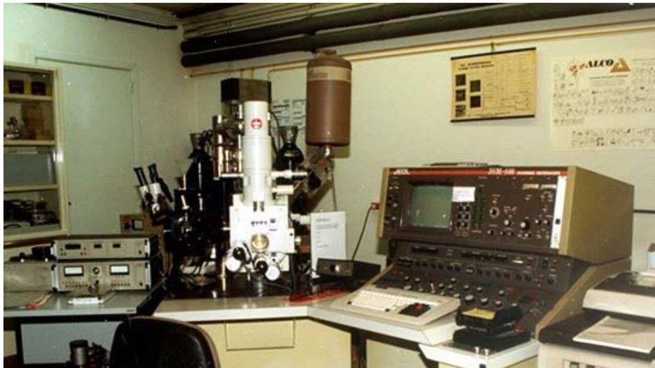
Figura 3-14.- Microscópio electrónico de barrido Jeol JSM-840.
