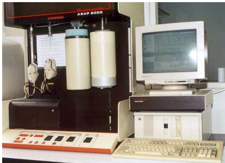
Figura 3-13.- Porosímetro Micromeritics Asap 2000, utilizado en la determinación de superficies BET.
