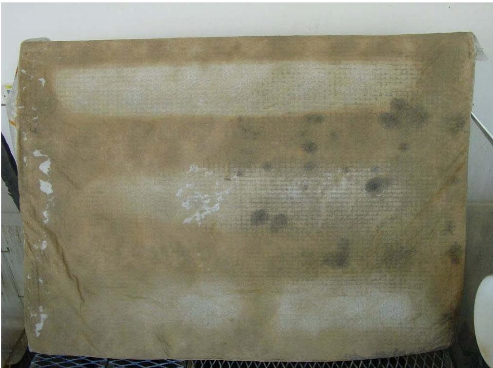
Foto IX.12. Imagen del geotextil luego de finalizada la etapa E1 del Ensayo 3.
