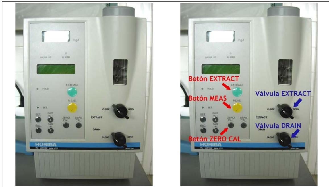
Figura 3.13. Analizador de contenido de aceite en agua HORIBA OCMA-310.
