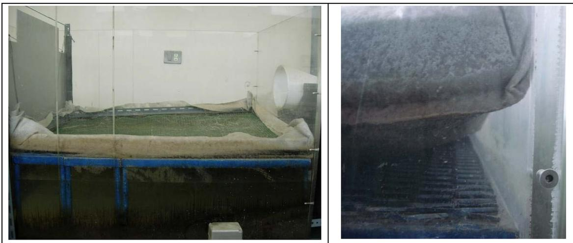
Figura 4.2. Desplazamiento del sistema de filtrado producto de la fuerza de empuje ejercida por el agua.
