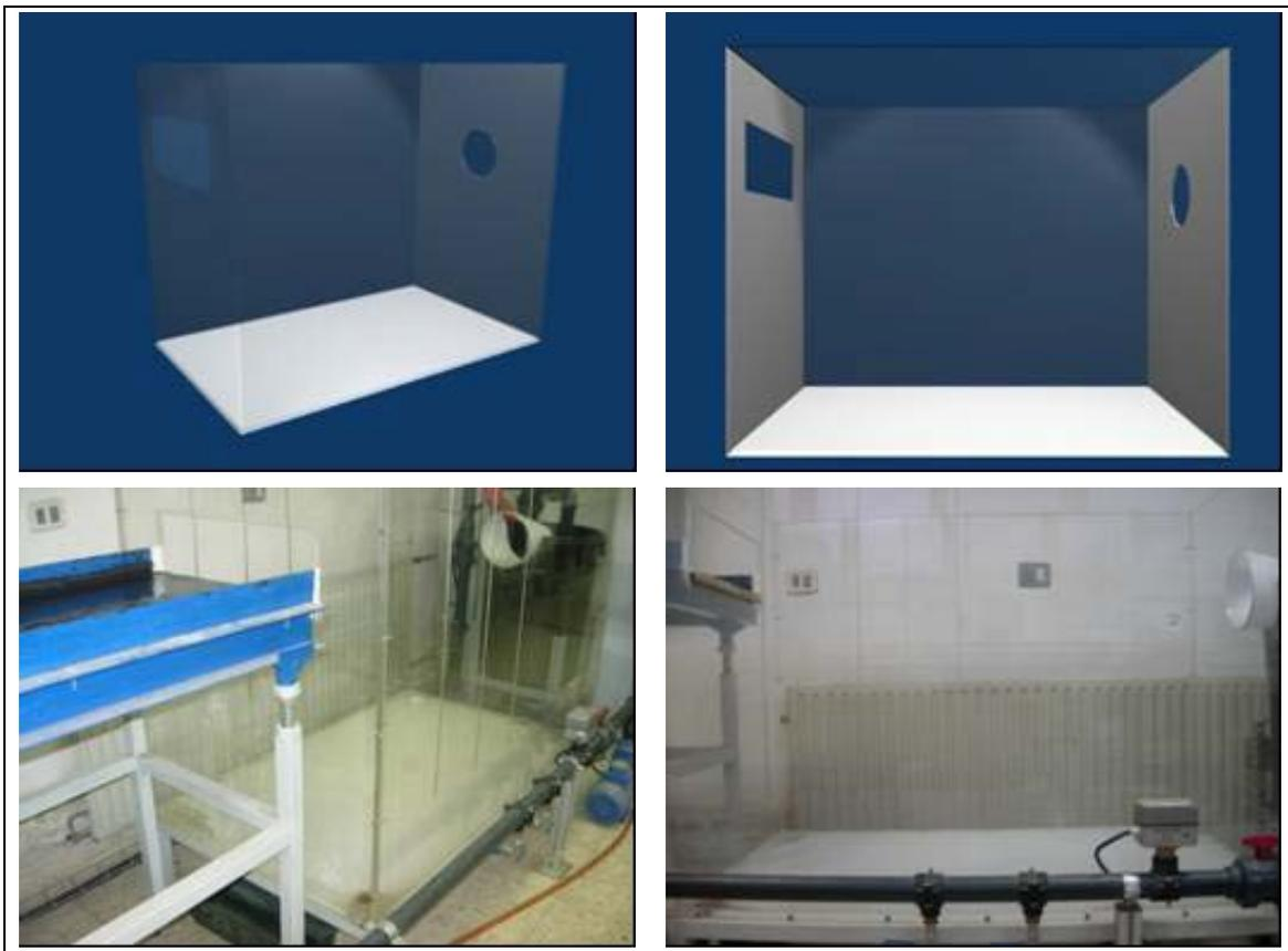
Figura 3.2. Estructura de metacrilato del prototipo de SCPT.
