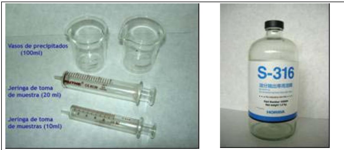
Figura 3.12. Materiales complementarios empleados en el análisis de muestras de agua contaminada con aceites.
