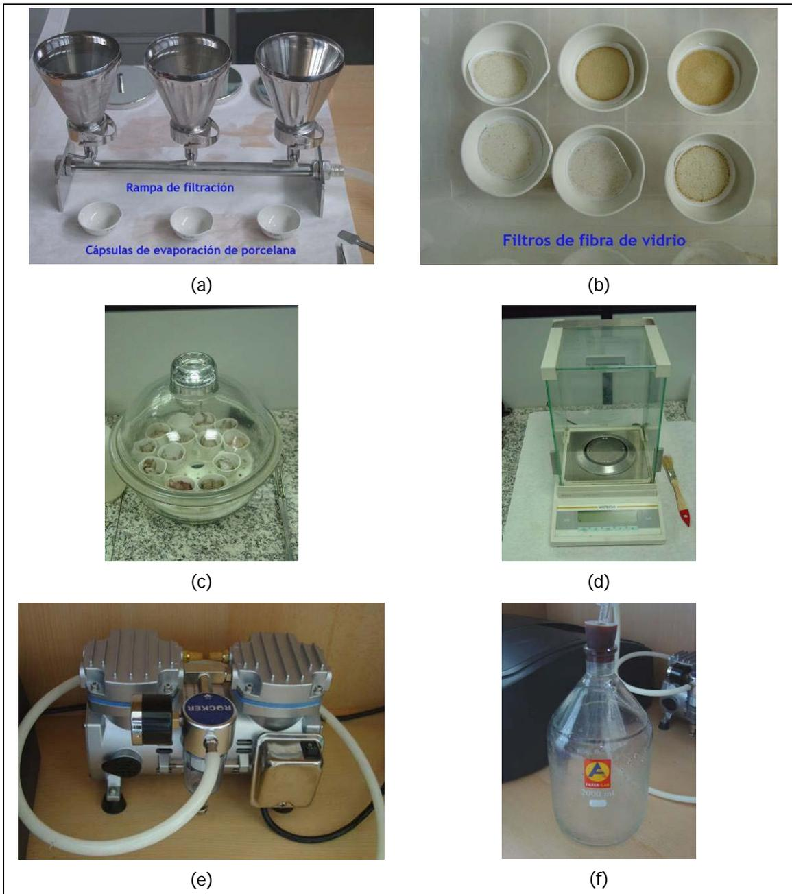
Figura 3.11. Imágenes de los materiales empleados en los análisis de sólido suspendidos.
