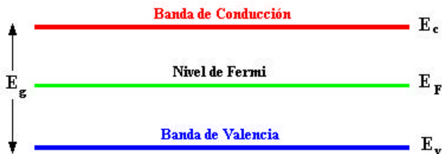
Figura 1.1 Diagrama de bandas de energía para un dispositivo semiconductor no dopado, o semiconductor intrínseco.
