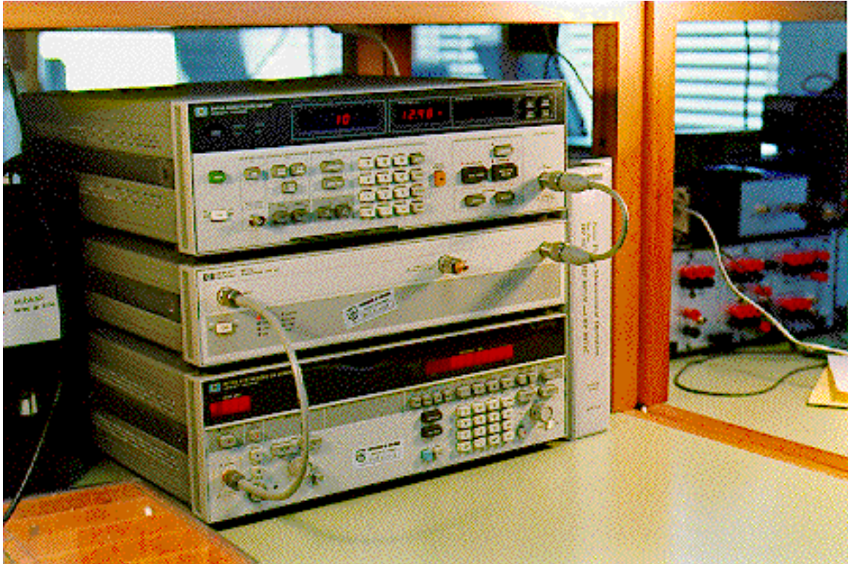
Figura 2.71 Fotografía del sistema de medida de figura de ruido digital HP8970U.
