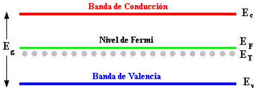
Figura 1.4 Diagrama de bandas para un semiconductor con exceso de niveles profundos.
