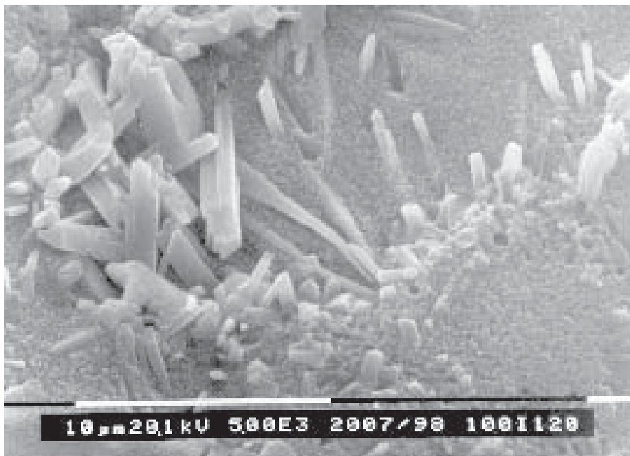
Figura 5.81. Fotografía de la microestructura del vidrioado tratado térmicamente a 1000°C durante 120 minutos.
