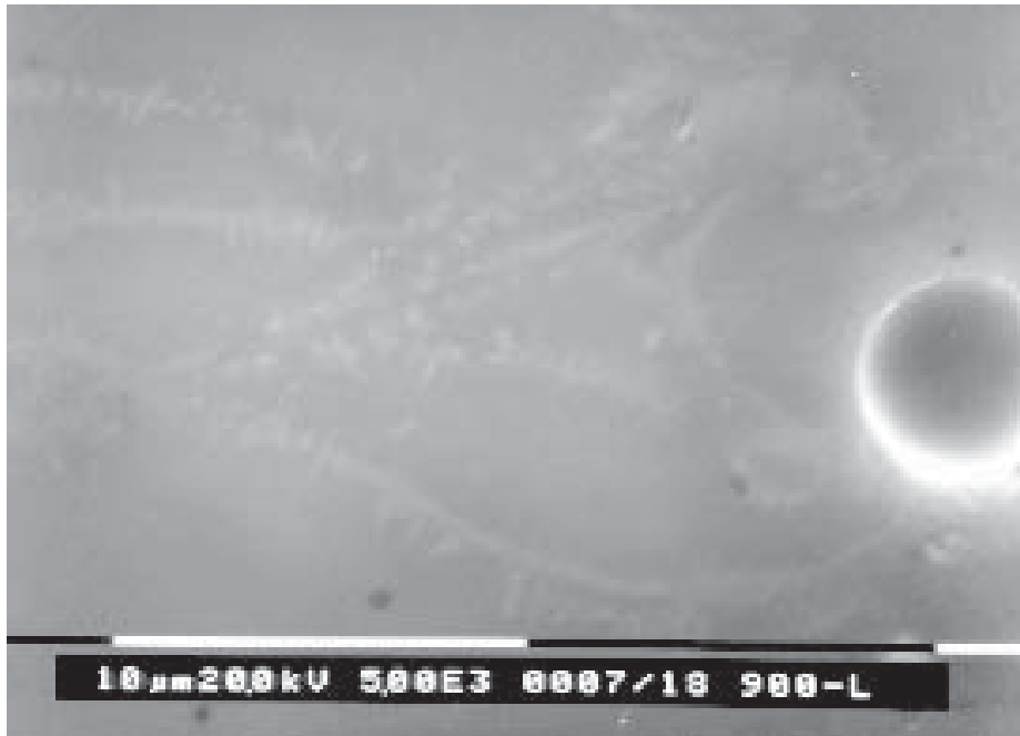
Figura 5.41. Fotografía de la microestructura del vidrioado cocido a 900°C de temperatura máxima.
