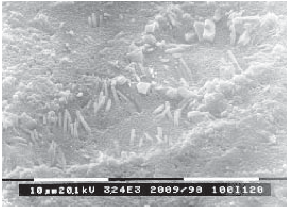
Figura 5.80. Fotografía de la microestructura del vidrioado tratado térmicamente a 1000°C durante 120 minutos.
