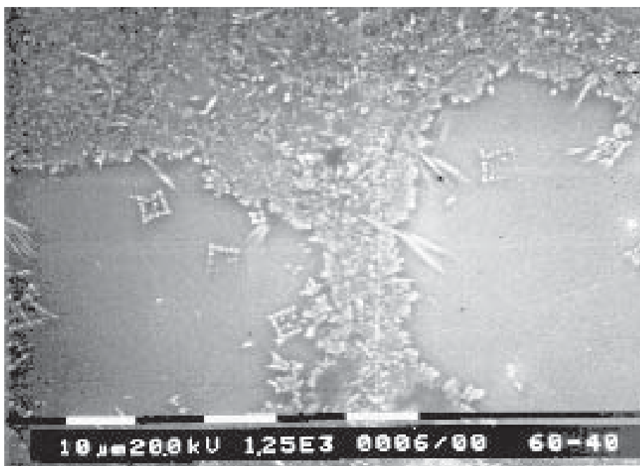
Figura 5.56. Fotografía de la microestructura de la probeta observada al tratar térmicamente la fracción 40 \leq D_p \leq 60 \mu\text{m} de la frita 18 a 1050^\circ\text{C} con una velocidad de calentamiento de 5 \text{ K/min} .
