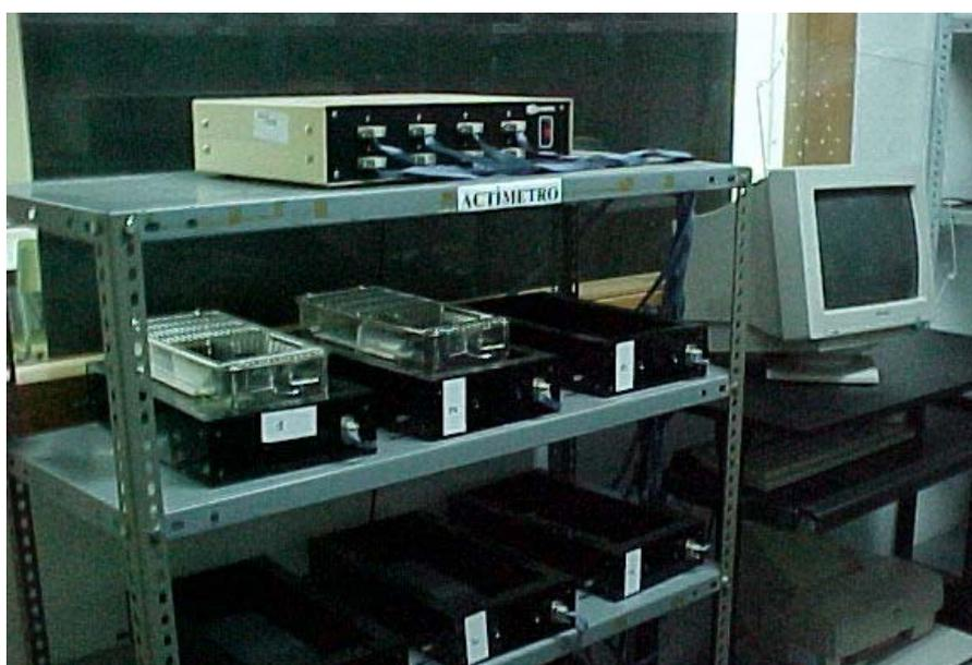
Fig. 6.6.1: Actímetro por Infrarrojos
